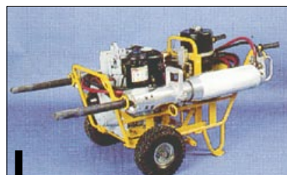
Fot. 6. Zespół rozłupiarki hydraulicznej systemu Darda
